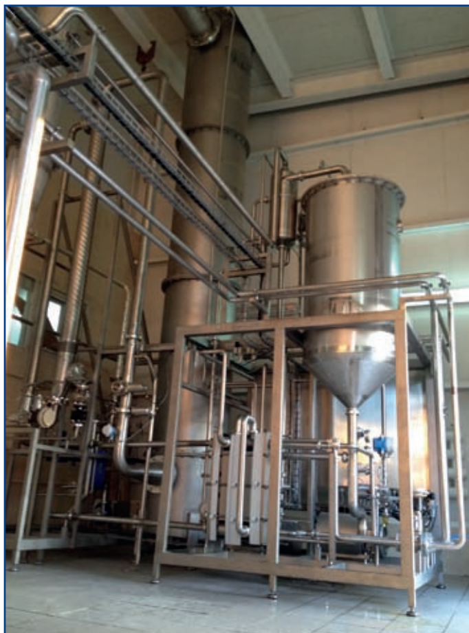
Komora odgazowywania i kolumna odpędowa w module dealkoholizacji Alfa Laval.
