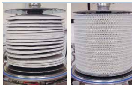
Rys. 5. Odształcenie widoczne po 21 cyklach parowych w tradycyjnym module dyskowym (po lewej). Moduł SD II (po prawej) zachowują swój kształt, utrzymując oddzielone od siebie, niezatkane i gotowe do filtrowania komórki
