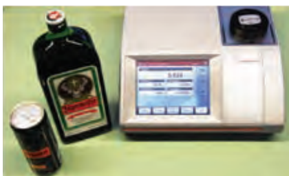
Refraktometr Abbemat 550 służący do pomiaru stężenia płynnego cukru oraz kontroli jakości surowców i produktów gotowych do spożycia
