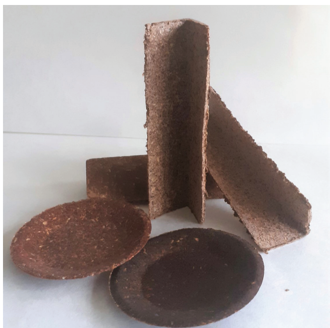
Rys.2 Wypraski 3D otrzymane z wytłoków jabłkowych w Laboratorium Materiałów i Opakowań Jednostkowych Łukasiewicz ŁIT
